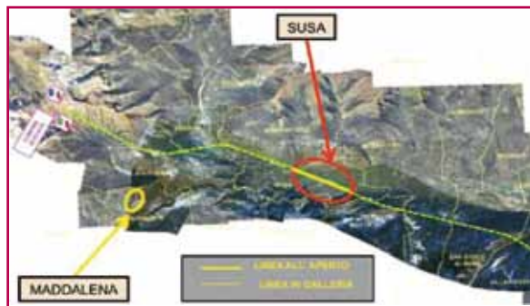
Schema del tratto di valico della nuova linea Torino-Lione, con indicate le due sole parti in superficie
