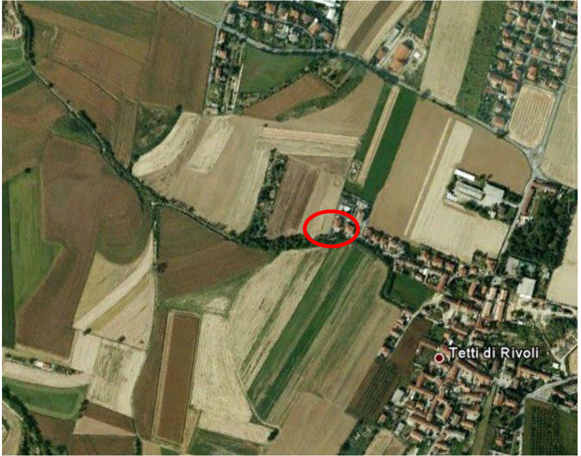
Figura 2-6 – A monte di Tetti Neirotti si sviluppa una strada che prosegue verso Ovest (a destra della foto). La strada in parola, incassata nella parte terminale, convoglia verso la frazione gli apporti dei campi laterali (dove allagamenti anche fastidiosi). Non risulta identificabile comunque una rete idrografica propriamente sviluppata. L'edificio inquadrato è stato allagato nel 1992 da un nubifragio che aveva determinato una corrente con circa 80 cm di profondità sulla strada (da GoogleEarth™).
